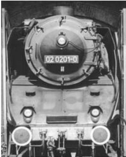
Hier siehst du die Front einer Dampflokomotive und du sollst einiges über den Nummernaufbau erfahren. Die beiden ersten Stellen sind die Baureihenummer, dann folgt die Ordnungsnummer. An den ersten beiden Stellen **02** kannst du erkennen, dass es sich um eine Schnellzug-Dampflokomotive handelt. Die folgende vierstelligen Zahl **0201** ist die Ordnungsnummer. Dann folgt als letztes die Kontrollziffer mit der die Nummer gegen Fehleingaben bei der elektronischen Verarbeitung abgesichert wird.
